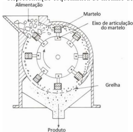
Figura 7 - Representação esquemática do moinho de martelos.
