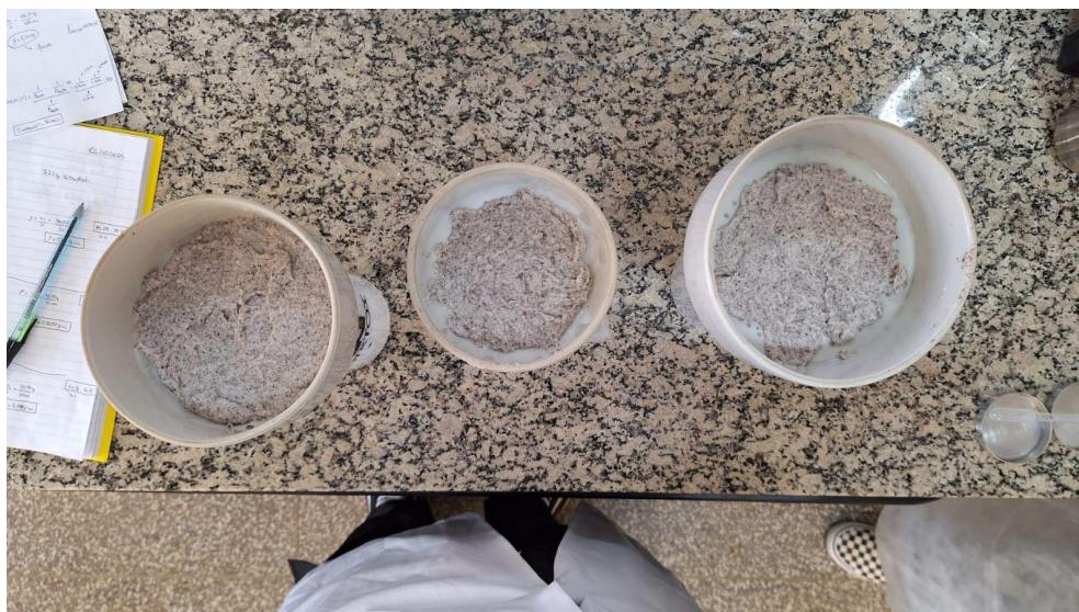
Figura 3: Sistema de análise para estabilidade da espuma. Fonte: Autores (2025)
