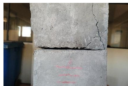
Figura 24 – Descontinuidade no contato entre os segmentos. Fonte: Autor
