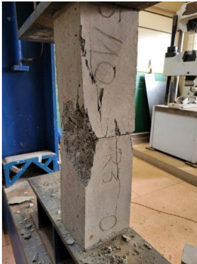
Figura 25 – Ruptura por esmagamento do concreto dos segmentos descontínuos. Fonte: Autor
