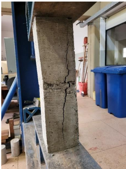
Figura 26 – Ruptura por concentração de tensões nos segmentos descontínuos. Fonte: Autor
