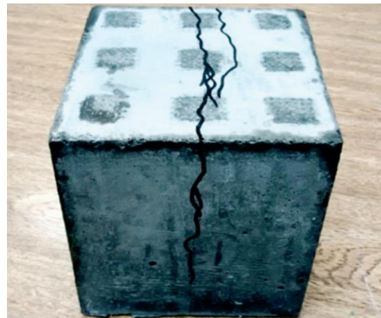
Figura 7 – Formação de fissuras nos ensaios de transferência de tensões de compressão em blocos com saliências na face ligada. Fonte: Ditz, 2016.
