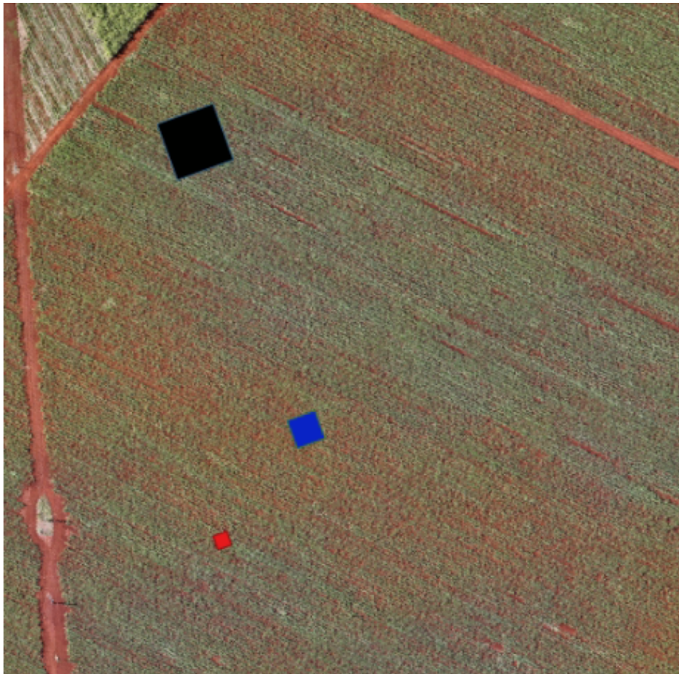
Figura 3.5: Retrato da real dimensão do tamanho do patch em relação ao tamanho da ortofoto. O quadrado em vermelho corresponde ao patch de 256 \times 256 , o quadrado em azul ao de 512 \times 512 pixels e o quadrado em preto ao de 1024 \times 1024 pixels.
