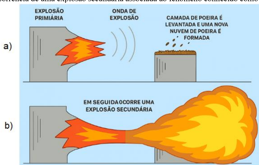
Figura 6 - Etapas do processo de explosão de poeira: (a) dispersão de uma camada de poeira depositada em decorrência da onda de choque gerada pela explosão primária; (b) suspensão das partículas e sua subsequente ignição, resultando na ocorrência de uma explosão secundária associada ao fenômeno conhecido como fireball .
