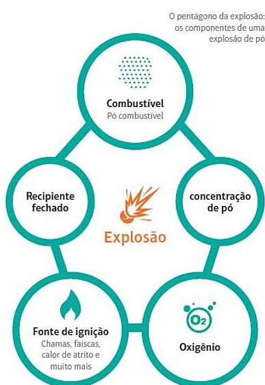
Figura 5 – Os componentes de uma explosão de pó: Pentágono de explosão.
