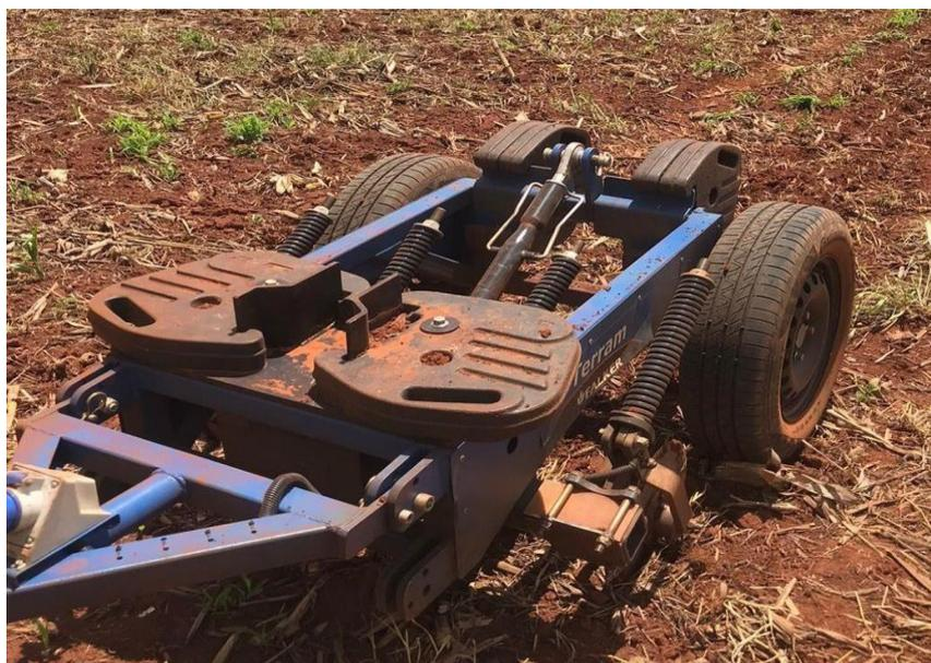
Figura 1. Implemento utilizado para mensuração da condutividade elétrica aparente do solo
