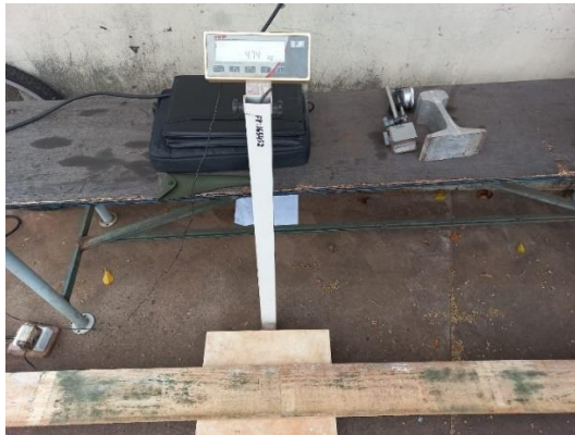
Figura 26. Peça de madeira sendo pesada em balança industrial
