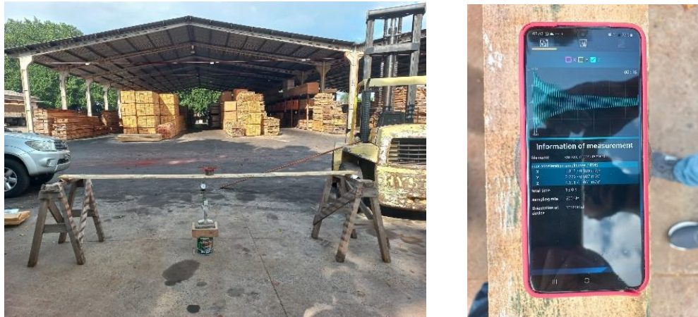
Figura 28. Smartphone posicionado para teste de vibração.
