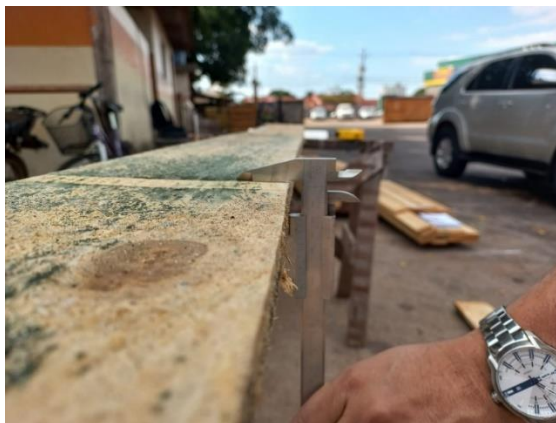
Figura 27. Medição da espessura da peça de madeira utilizando paquímetro
