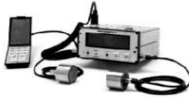
Figura 3. Equipamento para avaliação não-destrutiva por meio de emissão de ultrassom
