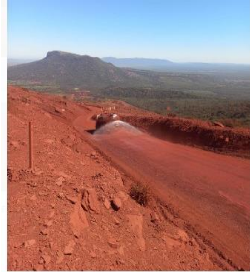
Figura 6. Umectação da vias internas na mineradora
