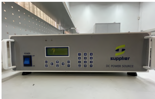
Figura 23 – Fonte de tensão CC - Supplier FCCT 250-50-i
