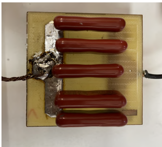
(a) Banco de capacitores do primário
