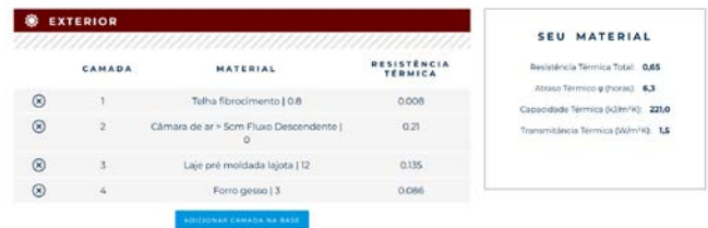
Figura 17 – Parâmetros cobertura. Fonte: Projeteer
