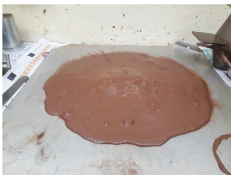
a) Mistura mal homogeneizada
