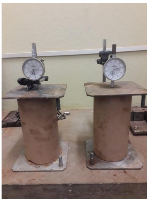
Figura 14. Ensaio de avaliação da retração livre de 24h até 7 dias de idade
