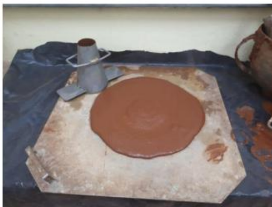
Figura 11. Execução do ensaio de Slump Flow
