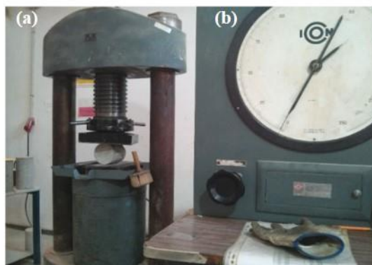
Figura 6 - Indução de fissuras em amostra cilíndrica de concreto com fibras metálica por meio do ensaio de compressão diametral
