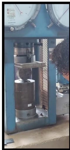
Figura 16 - Processo de fissuração dos discos amostras
