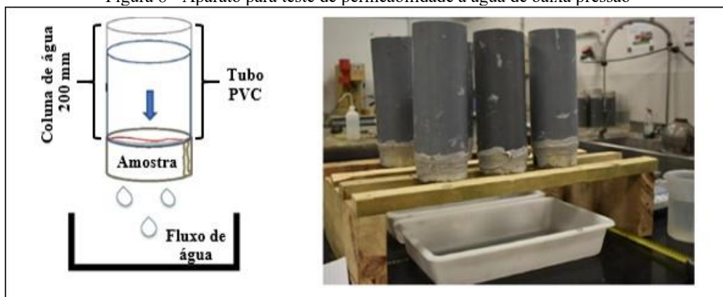
Figura 8 - Aparato para teste de permeabilidade à água de baixa pressão
