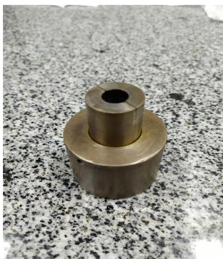
Figura 3 - Molde utilizado para o processo de resfriamento.
