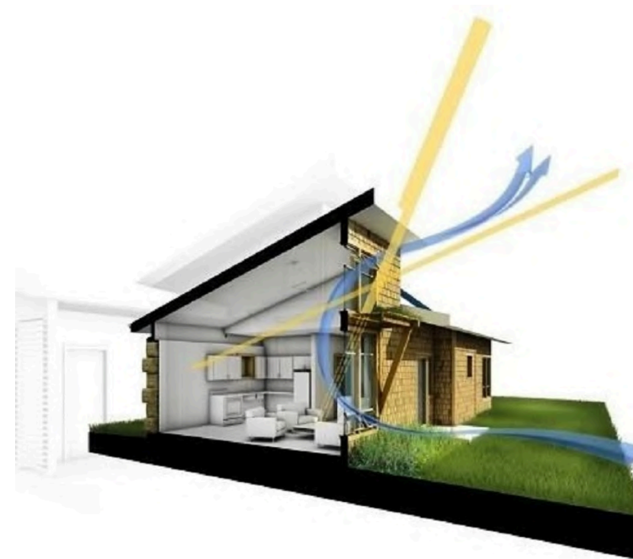
Figura 24 – Diagrama representando eficiente Ventilação e Iluminação Natural
