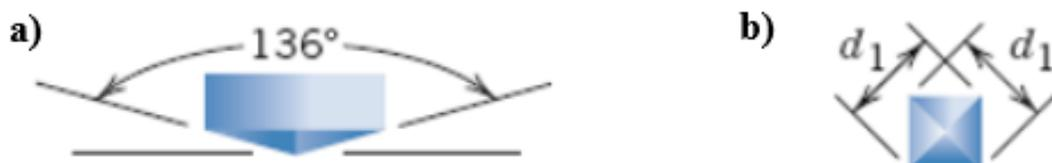
No ensaio de microdureza Vickers um pequeno penetrador de diamante de formato piramidal é pressionado contra a superfície do corpo de prova. A área da impressão resultante é observada e medida com um microscópio. A razão entre a força de carga aplicada e a área da impressão resultante equivale ao valor de dureza Vickers HV.
