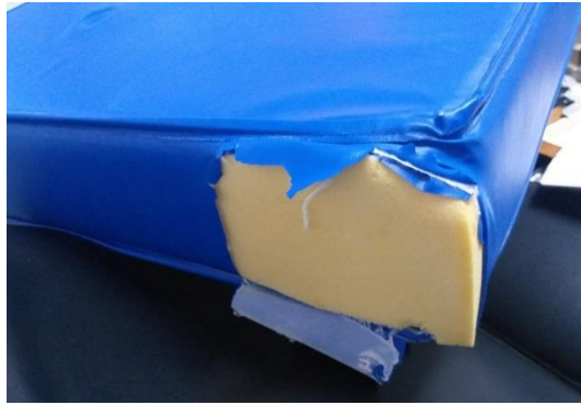
Figura 1- Condições do revestimento impermeável de um colchão hospitalar em uso, Campo Grande, MS – 2021
