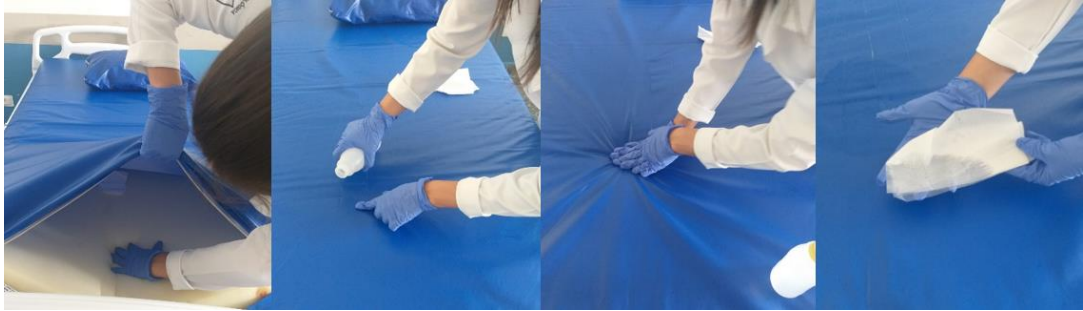
Figura 2 – Etapas do teste de água realizado para verificar permeabilidade do revestimento
