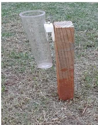
Figura 4 - Pluviômetro milimetrado.
