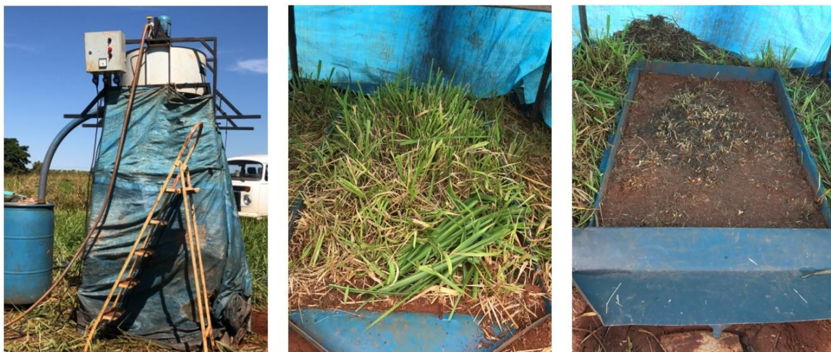
Figura 3.1 – Simulador portátil de chuva e as parcelas testes, com e sem cobertura vegetal.
