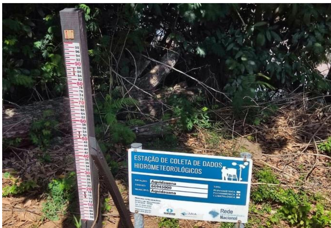
Figura 15. Régua Linimétrica instalada no lado direito do Rio Aquidauana
