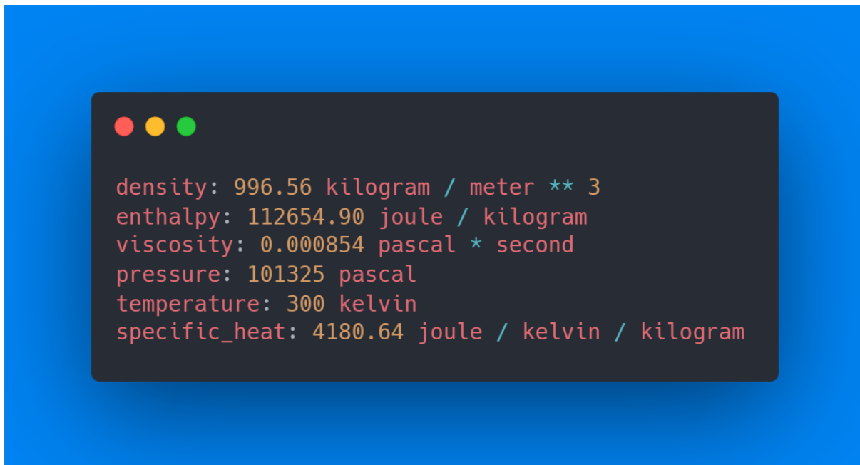
Figura 9 – Propriedades termodinâmicas da água calculadas a 300K e 101,3kPa.
