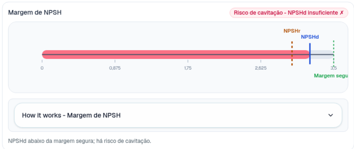
Figura 19 – Card da margem de NPSH
