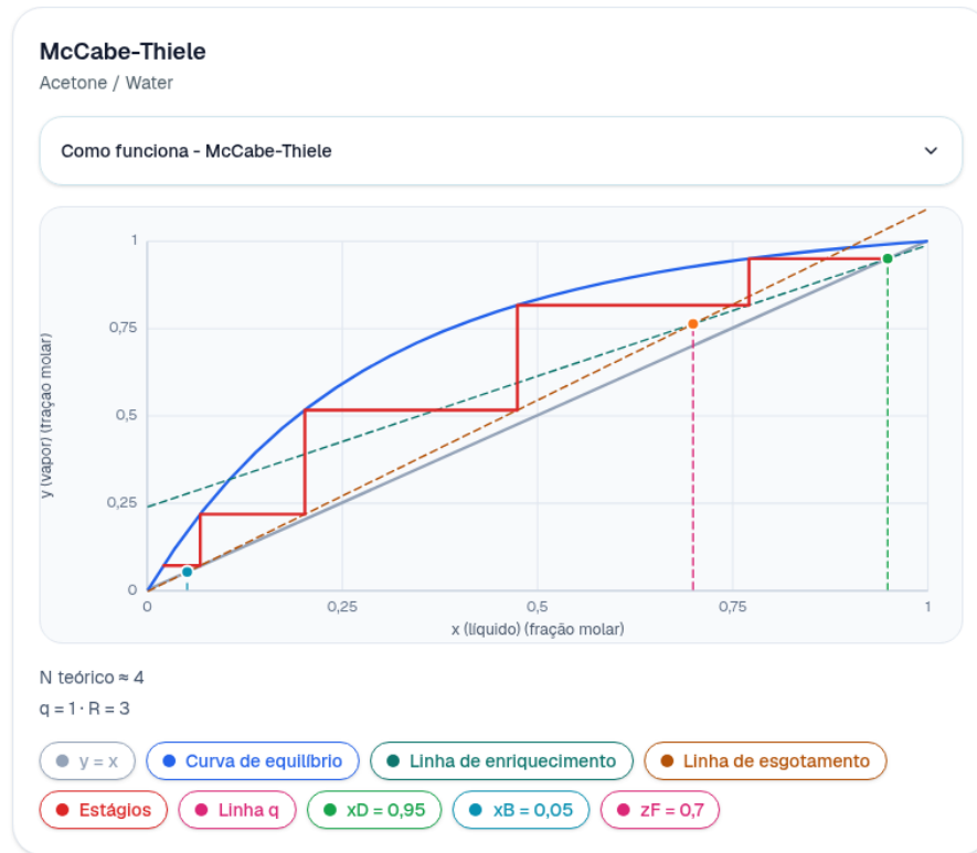
Figura 26 – Card do diagrama de McCabe-Thiele gerado a partir do equilíbrio binário
