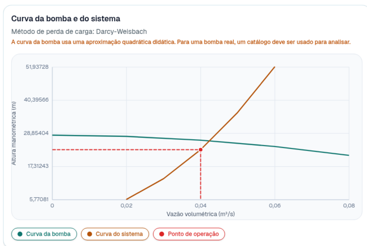
Figura 18 – Card da curva da bomba e do sistema
