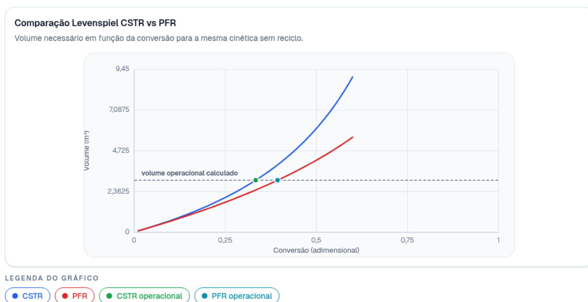
Figura 21 – Card do diagrama de Levenspiel comparando reatores CSTR e PFR
