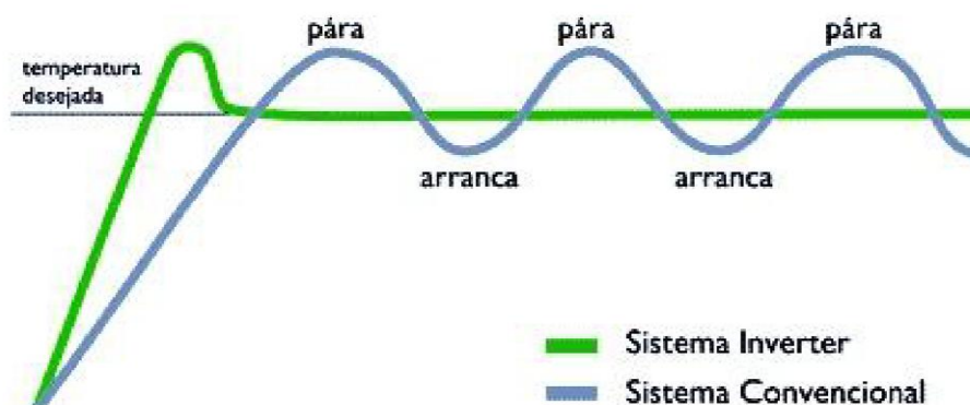
Figura 7 - Comparação do sistema inverter x convencional
