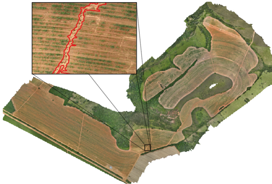
Figura 1: Ortofoto completa da área analisada, destacando-se em detalhe (zoom) a região com erosão identificada e anotada em vermelho por especialista.
