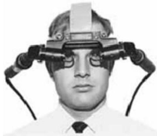
Figura 2 - Head Mounted Display (HMD) desenvolvido por Ivan Sutherland. Fonte: SUTHERLAND (1968).
