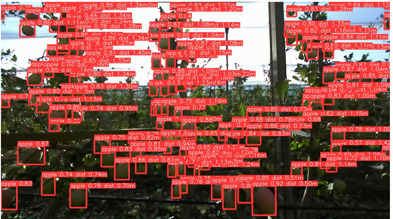
Figura 4.7: Detecção no frame capturado contra a luz do sol, a 60cm.
