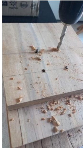
Figura 4: Alinhamento e pré-furo das peças.
