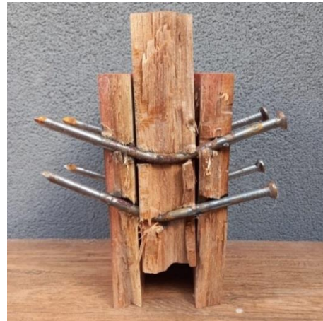
Figura 15: Modo de falha real em um corpo de prova aberto.
