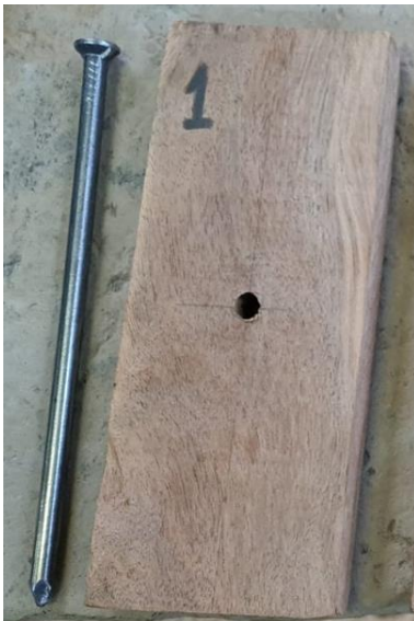
Figura 6: Corpo de prova de madeira preparado com pré-furo de acordo com NBR 7190/2022 e pino metálico de 7,6 mm.
