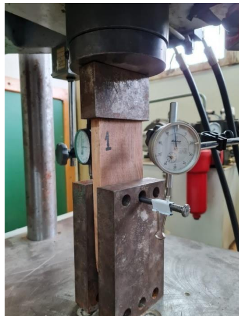
Figura 7: Montagem do esquema para medir deslocamentos na máquina universal com relógios comparadores.
