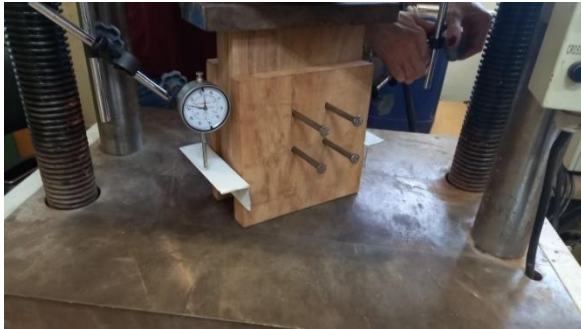
Figura 12: Montagem do corpo de prova na máquina de ensaios.
