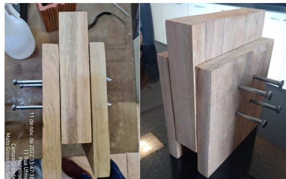
Figura 11: Corpo de prova de madeira preparado com pré-furo de acordo com NBR 7190-5/2022 e pinos metálicos de 7,6 mm.
