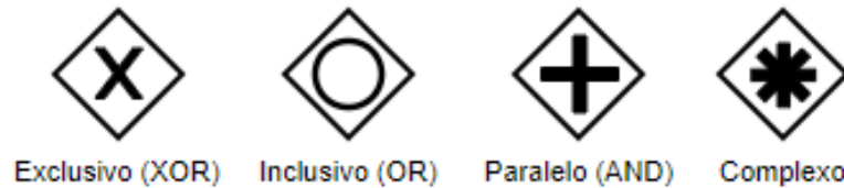
Figura 7 – Tipos de desvio em BPMN (adaptada de Lerner et al. (2010))
