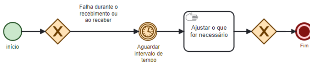
Figura 47 – Subprocesso de tratamento de exceções de recebimento associado à tarefa “Receber chamado”
