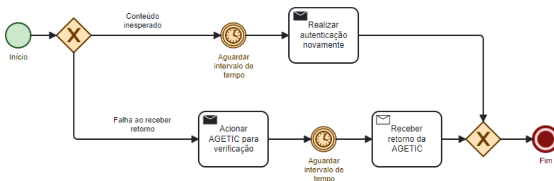
Figura 43 – Subprocesso de tratamento de exceções no recebimento associado à tarefa “Receber retorno da autenticação”
