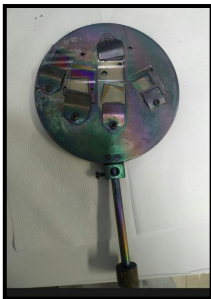
Figura 15. Porta substratos com amostras fixadas em sua superfície. (A autora).
