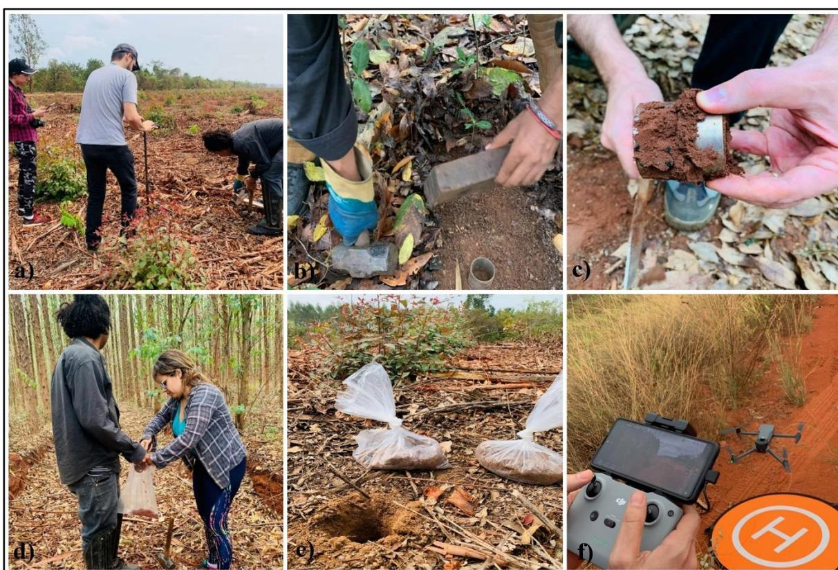
Legenda: a) Tradagem do solo; b) Aprofundamento do anel volumétrico; c) Anel volumétrico com a amostra de solo; d) Armazenamento em sacos plásticos etiquetados; e) Amostras de solo tradado em duplicata; f) Levantamento do VANT.
