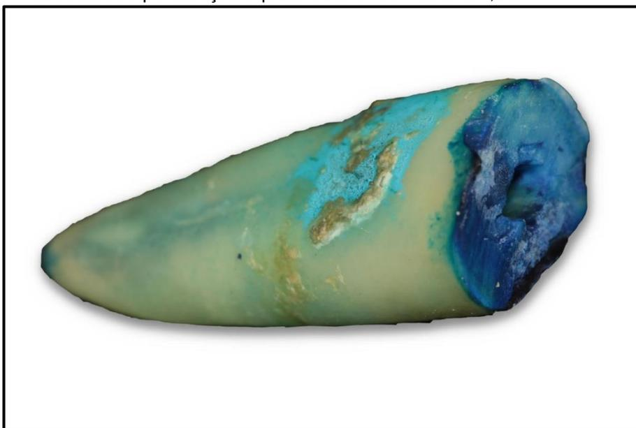
As raízes foram então seccionadas perpendicularmente ao longo seu eixo com o auxílio de máquina de corte metalográfico dotada de disco diamantado (Isomet 1000, Buehler, Lake Buff, IL, EUA), obtendo-se fatias com 0,6 mm de espessura (Figura 5).
