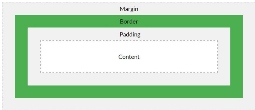
Figura 6: Diagrama ilustrando o Box Model do CSS
