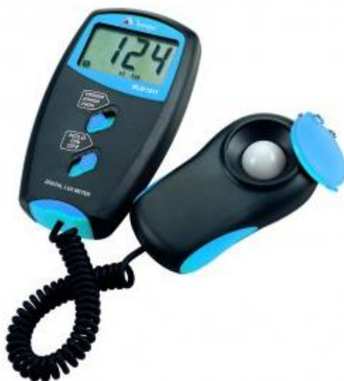
Figura 37. Luxímetro Digital Lux Meter MLM-1011 (Minipa) utilizado nas medições de iluminância (precisão \pm 4\% na leitura).
