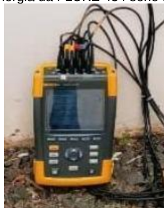
Figura 41. Analisador de energia da FLUKE 434 série II - Energy Analyzer .
