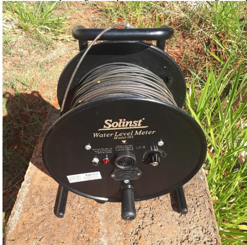
Medidor de nível utilizado para registrar a profundidade do nível de água nos piezômetros.
