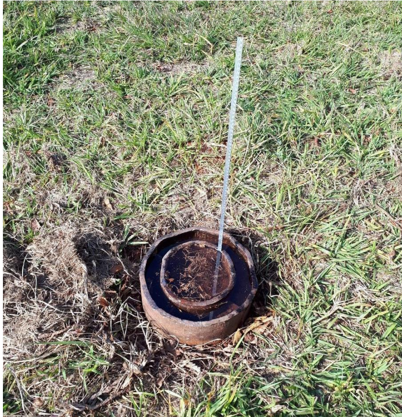
Anéis concêntricos utilizados no teste de infiltração.
