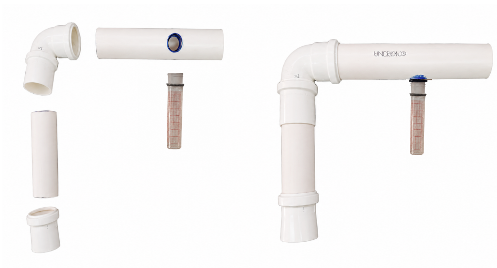
Figura 1 – Montagem da estrutura para os ensaios na Célula de Arnold.
