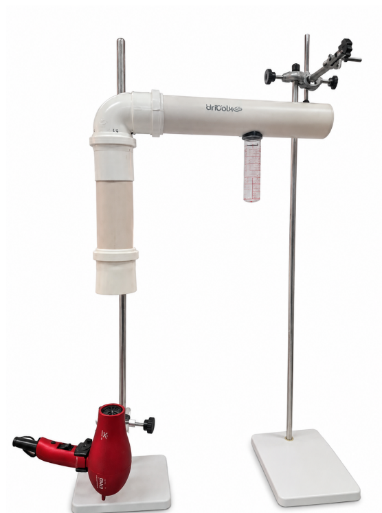
Figura 2 – Experimento da Célula de Arnold.
