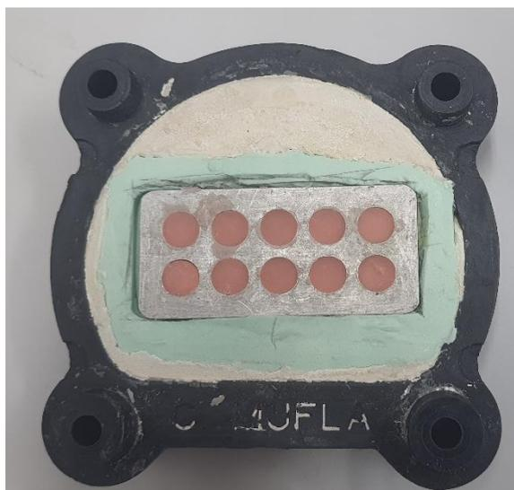
**Figura 3:** Amostras de Resina Termopolimerizável no molde dentro da mufla de plástico
