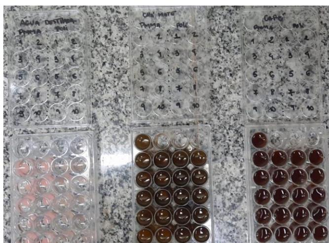
**Figura 7:** Corpos imersos nas bebidas e água destilada
