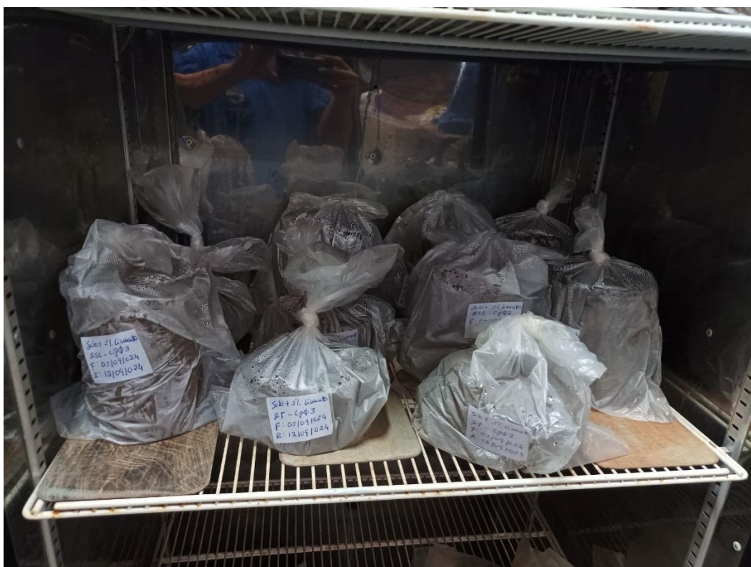
Figura 25. Corpos de prova na cura, para realização dos ensaios de compressão simples e tração por compressão diametral – LATRAN.
