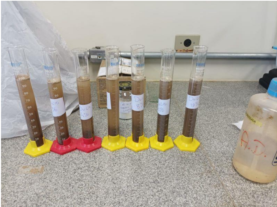
Figura 24. Ensaio pelo método físico-químico – estabilização com solo com o cimento – CP II.
