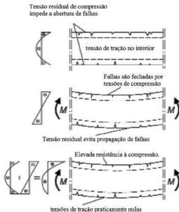
Figura 02. Efeito do processo de temperamento do vidro. [28]
