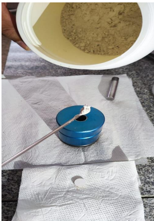
Figura 19. Amostra sendo preparada para ser prensada. Pastilha pronta.
