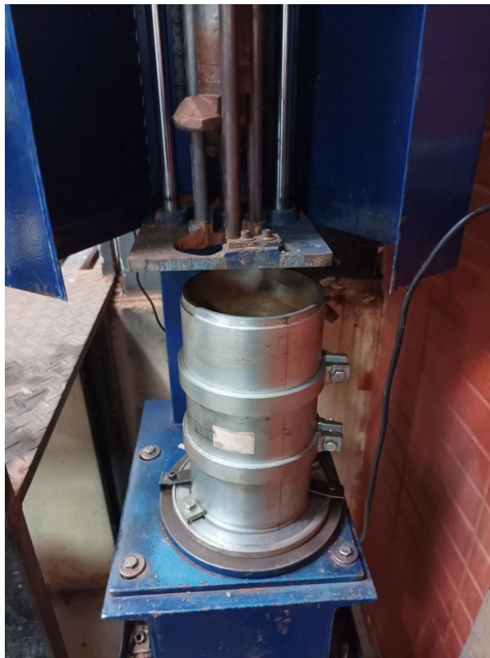
Figura 26. Compactação do corpo de prova no cilindro tripartido – LATRAN.
