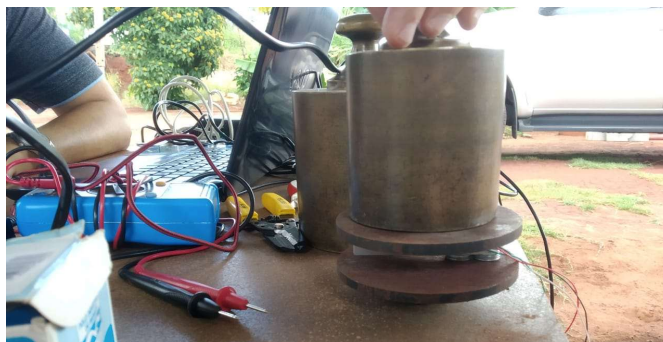
Figura 31. Calibração com peso padrão
