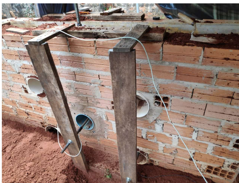
Figura 29. Fixação dos conjuntos de medição na versão 1
