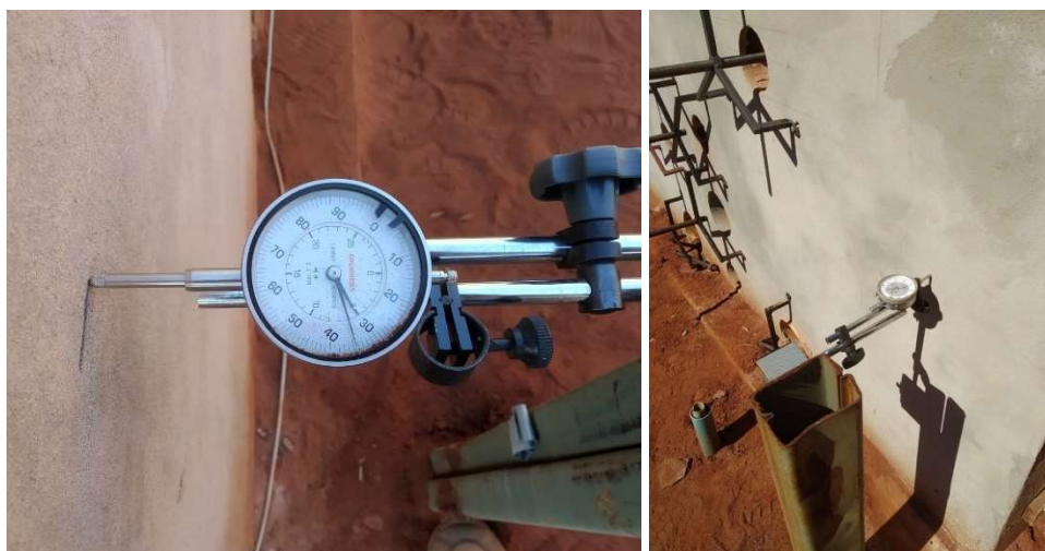
Figura 25. Relógio comparador posicionado na superfície externa do molde indeformável.
