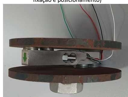
Calços para flexão do sensor, na imposição de um esforço na superfície do conjunto de medição
