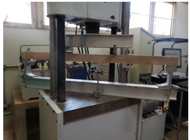
Figura 4 – Ensaio de flexão de peças estruturais. Fonte: Autor (2022)
