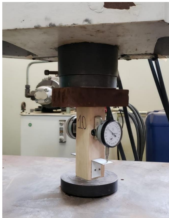
Figura 1 – Ensaio de compressão paralela às fibras de corpos de prova isentos de defeitos. Fonte: Autor (2022)
