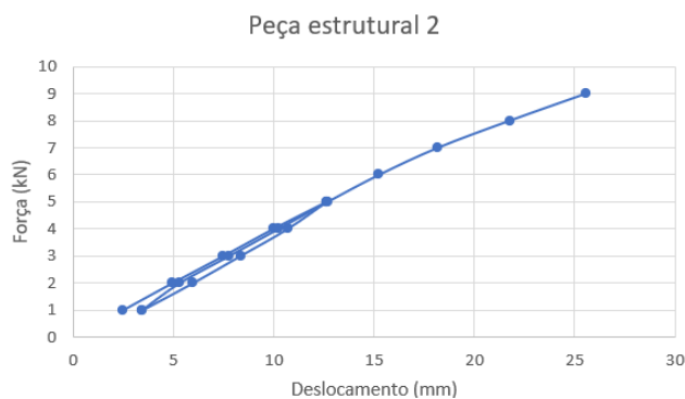
Figura 6 – Diagrama de força versus deslocamento para peça estrutural 2. Fonte: Autor (2022)
