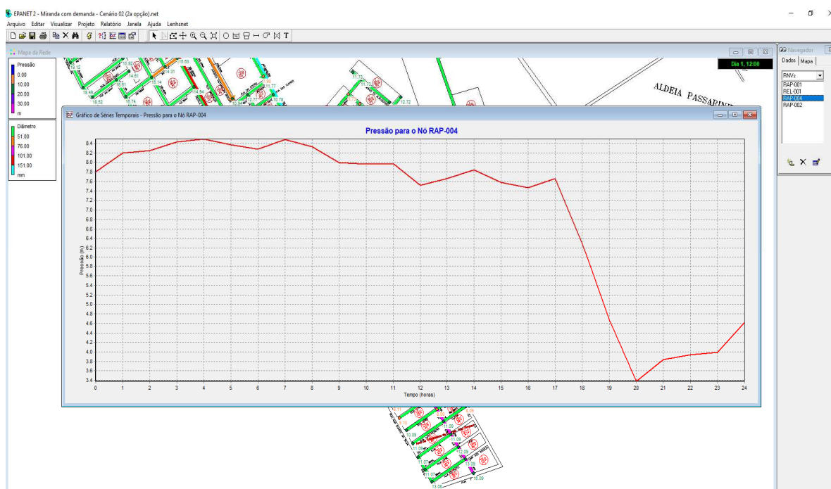
Figura 25. Gráfico (pressão x tempo) – Reservatório RAP-004 (2ª opção - proposto)
