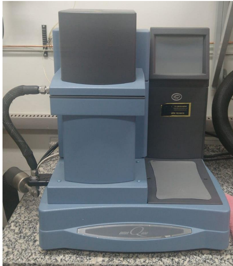
Figura 37 - Analisador Dinâmico Mecânico da TA Instruments, modelo DMA Q-800.
