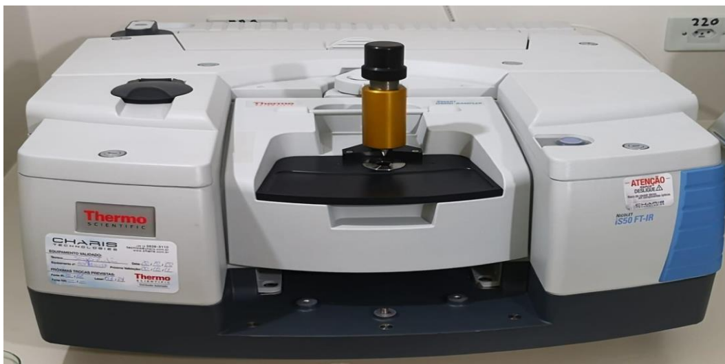
Figura 34 - Espectrômetro de Infravermelho da Thermo Scientific , modelo Nicolet IS5 .
