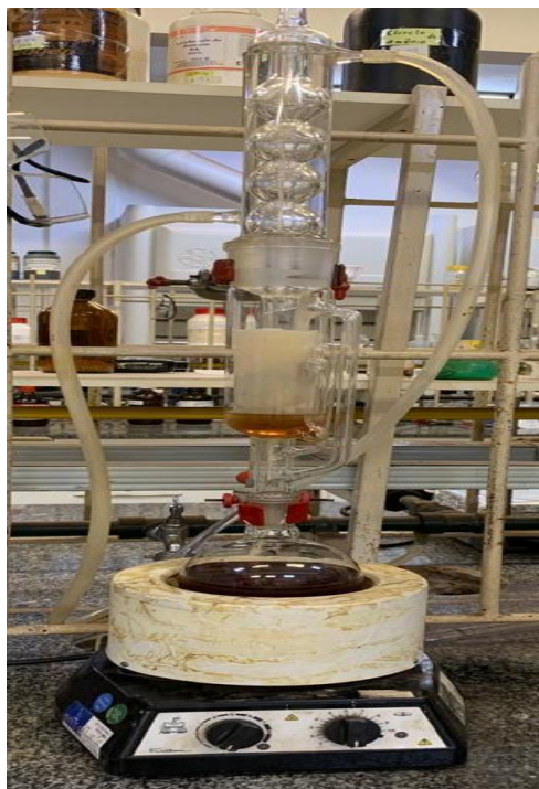
Figura 26 - Sistema para extração de LCC utilizando extrator Soxhlet .
