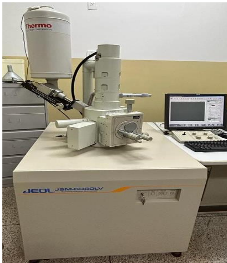
Figura 33 - Microscópio Eletrônico de Varredura da JEOL, modelo JSM-6380LV.
