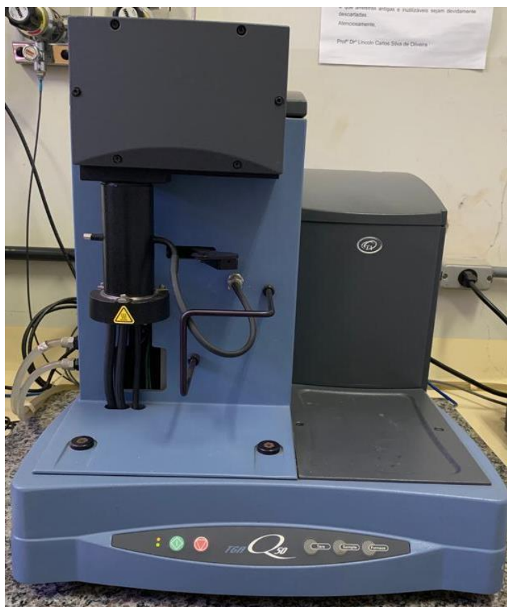
Figura 35 - Equipamento de Termogravimetria da TA Instruments , modelo TGA-Q50.
