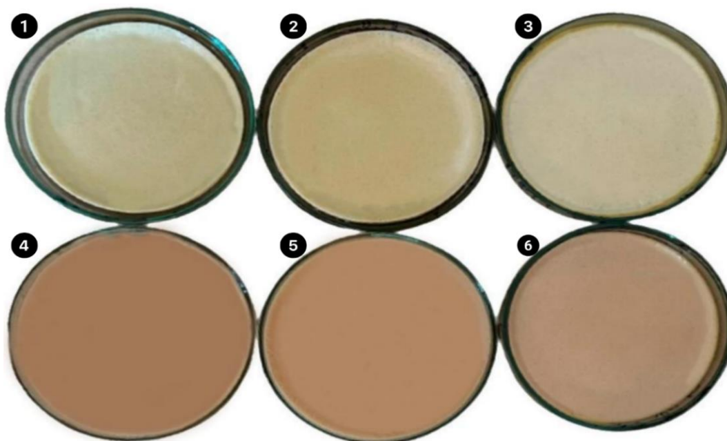
Figura 53 - Membrana de BN (1) e compósitos BN/CEL CO (2), BN/CEL BCA (3), BN/sLCC (4), BN/CEL CO/sLCC (5) e BN/CEL BCA/sLCC (6) após secagem.
