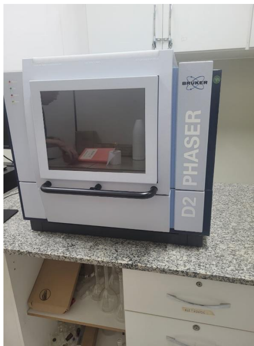
Imagem 9: Difratorômetro de raio x (Bruker - D2 Phaser) Instituto de Química-UFMS. Fonte: Própria
