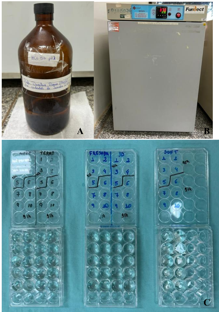
Figura 09: A. Ácido Clorídrico 5%. B. Estufa. C. Amostras imersas em HCL.
