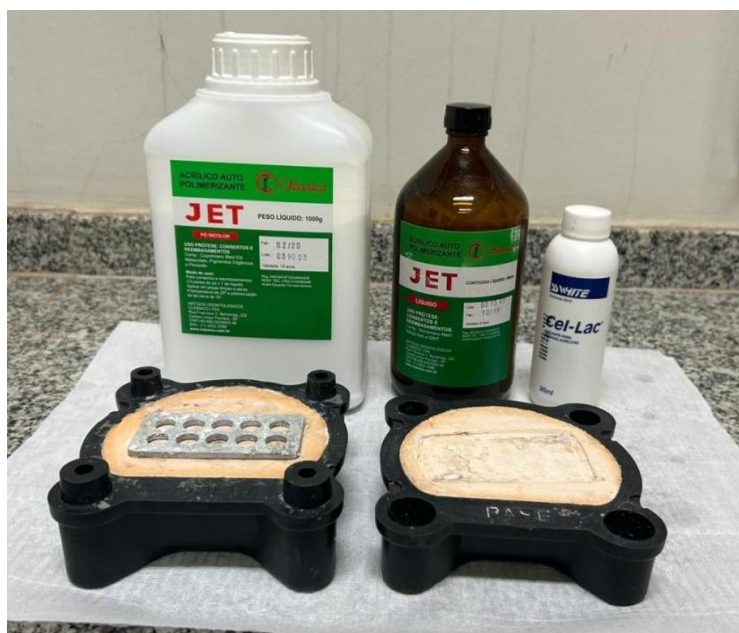
Figura 2: Confeção dos corpos de prova de resina acrílica autopolimerizável.
