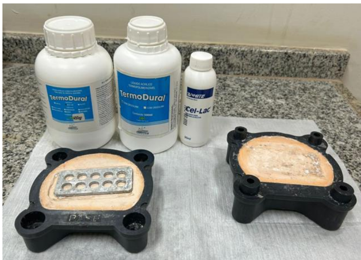
Figura 3: Confeção dos corpos de prova de resina acrílica termopolimerizável.
