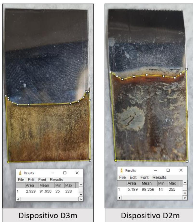
Figura 13 - Eletrodeposição da área efetiva dos eletrodos dos dispositivos.
