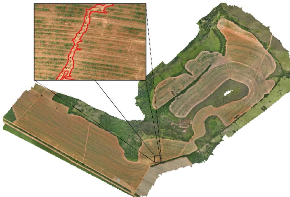
Figure 3: Ortofoto completa da área analisada, destacando-se em detalhe (zoom) a região com erosão identificada e anotada em vermelho por especialista.
