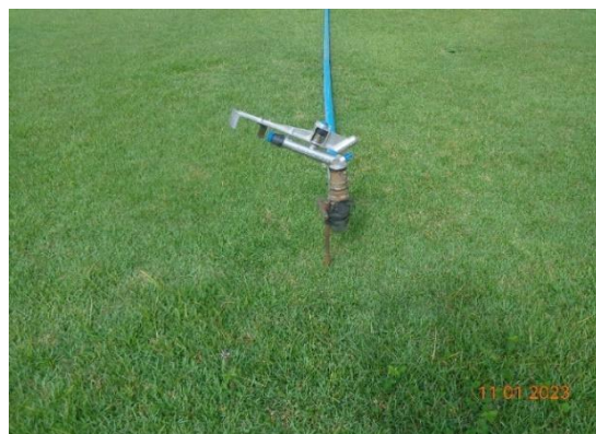
Figura 18. Aspersor de 2" para irrigação do gramado
