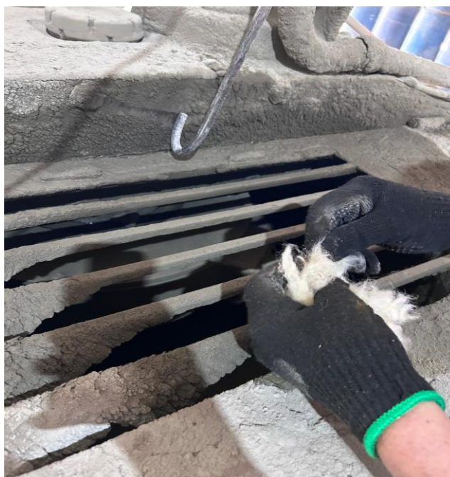
Figura 9 – Adição de lã manualmente no misturador planetário
