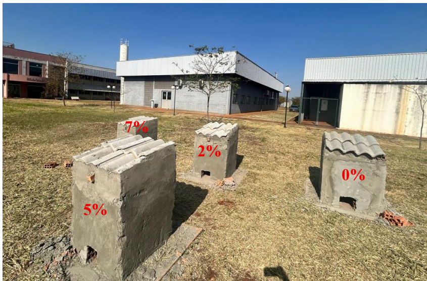
Figura 15 – Protótipos utilizados no ensaio de desempenho térmico, correspondentes aos teores de 0%, 2%, 5% e 7% de incorporação de lã
