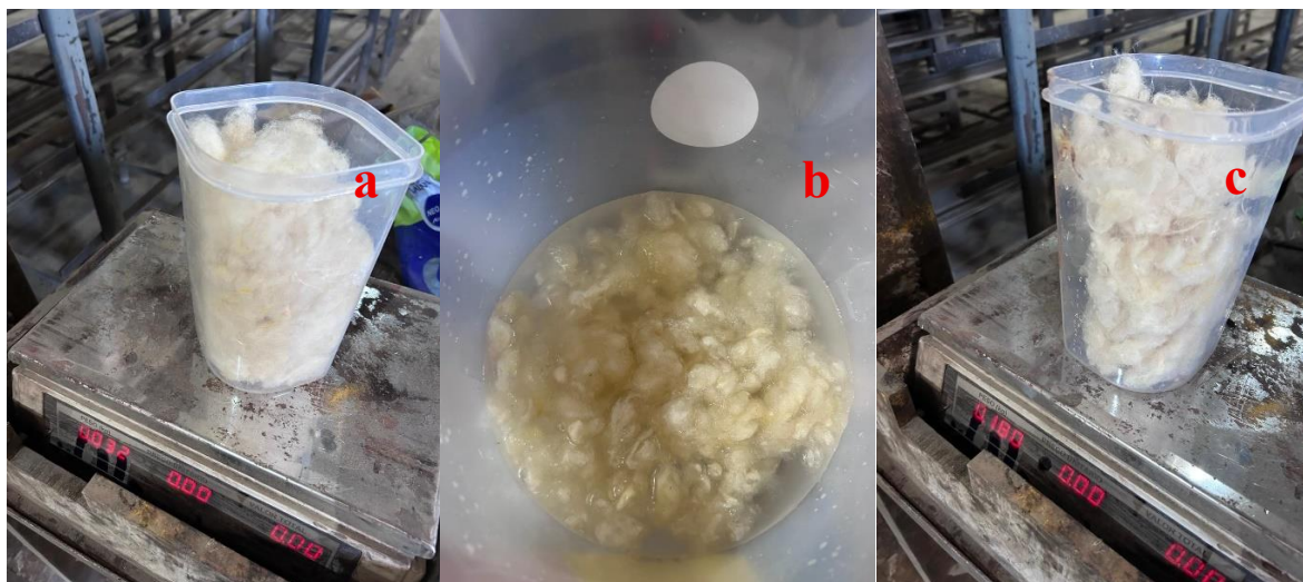
Figura 8 – Pré umedecimento da lã de ovinos pantaneiros para incorporação na mistura de concreto: a-) lã seca, b-) lã saturada e c-) lã levemente torcida
