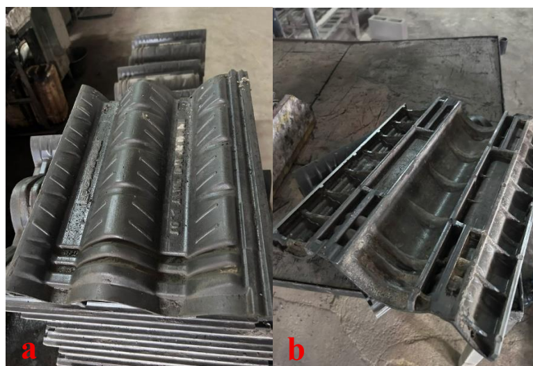
Figura 12 – a-) Forma de alumínio para telhas de concreto lado externo b-) Forma de alumínio para telhas de concreto lado interno
