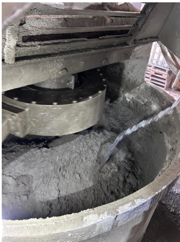
Figura 10 – Fotografia do misturador planetário - traço com adição de lã de ovinos pantaneiros
