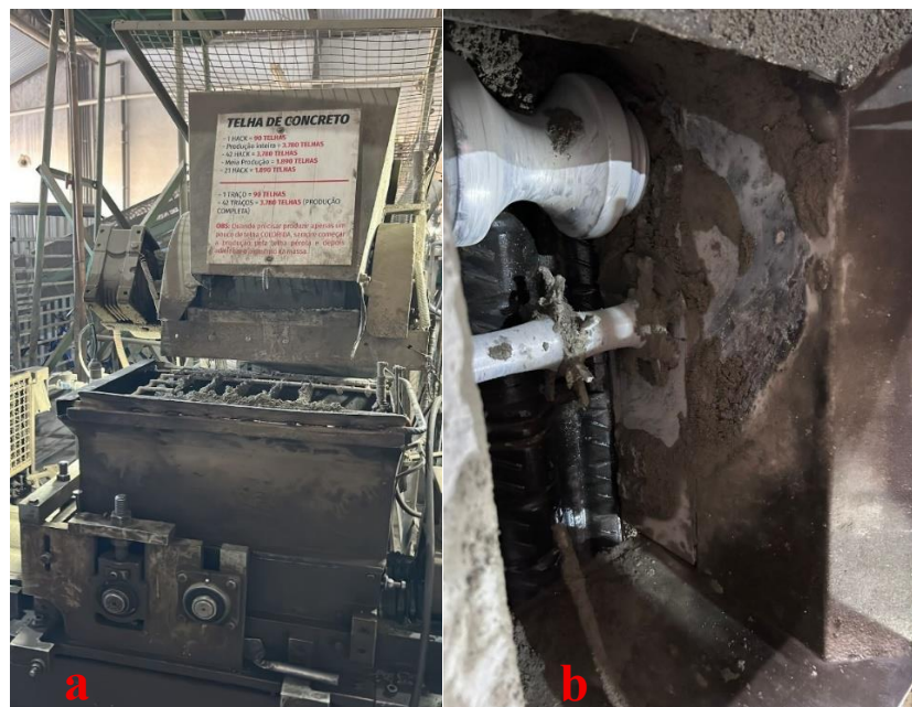
Figura 11 – a-) Extrusora de telhas de concreto e b-) Parte interna da extrusora de concreto, chamado de garfo compactador
