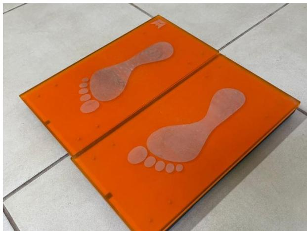
**Figura 2.** Equipamento K-Force utilizado para avaliar controle postural estático neste estudo.
