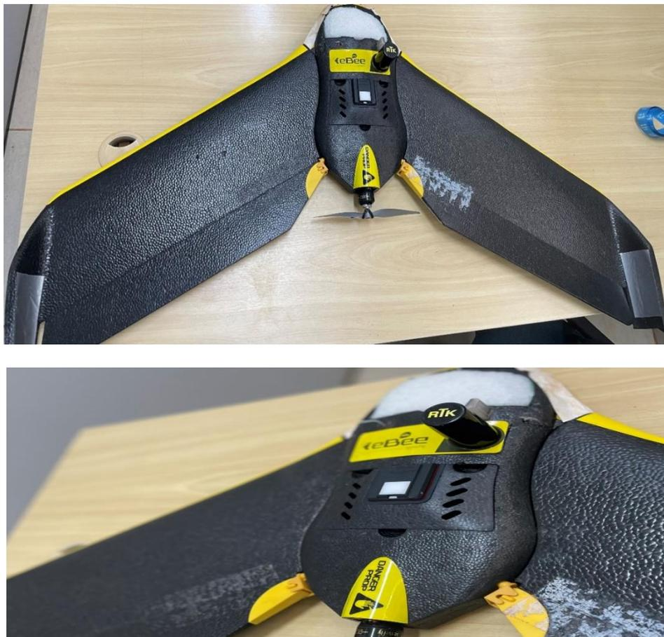
**Figura 1:** Aeronave remotamente pilotada (RPA) de asa fixa Sensefly eBee RTK.
