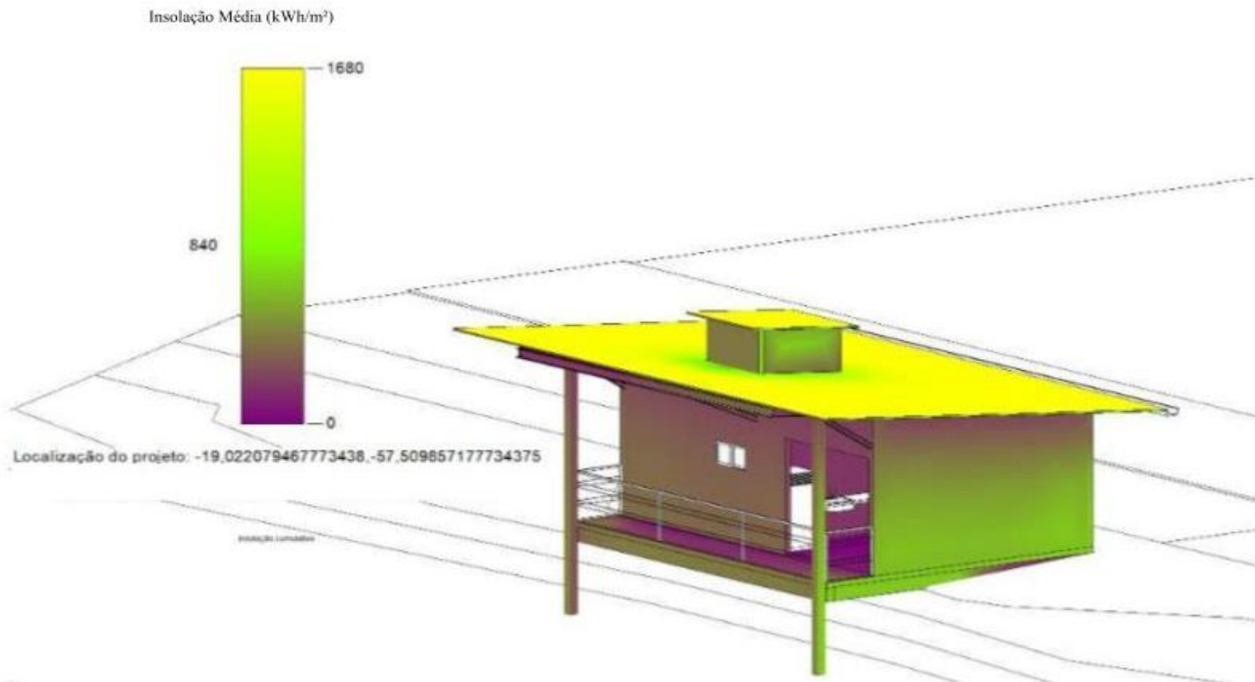
Figura 49 . Simulação de incidência solar
