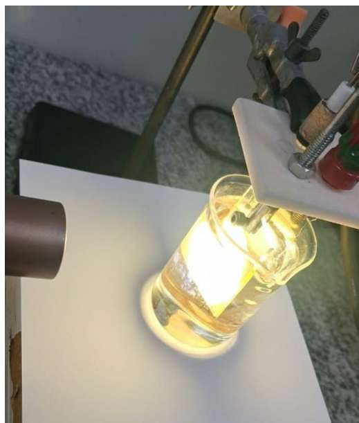
Figura 2. Arranjo experimental utilizado para as medidas em meia célula utilizando os eletrodos a base de BiVO 4 de 3 x 3 cm 2 de área geométrica ativa.
