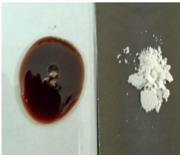
Figura 12. Fotografia de uma amostra do LCC técnico, lado esquerdo e o cardanol hidrogenado, lado direito.
